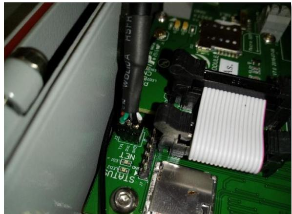
图. TTL 转 USB 连接
