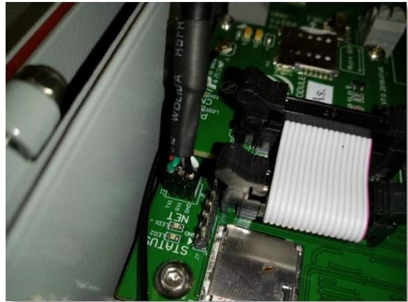
图. TTL 转 USB 连接
