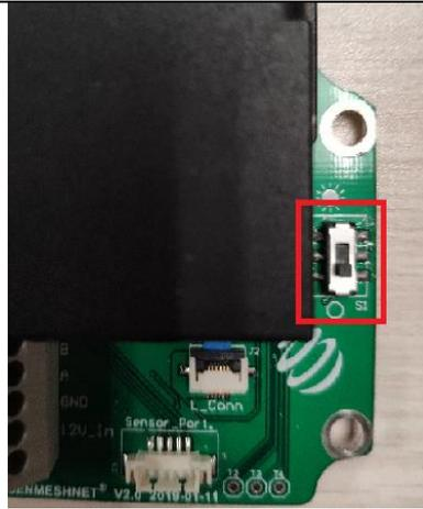
支点上电前后均可此开关，开关开启后，只有在下一次激光读数有效后，打点模式才会打开。
