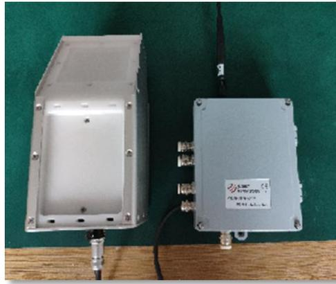
Figure. Radar Flow Meter Sensor Node.
